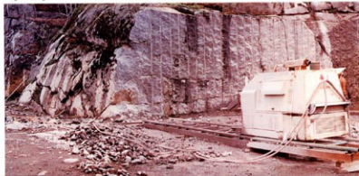
Figur 13. I steinbrudd sages såle og stoff ut med line. Skjæringsveggen slettsprenges med nøyaktig borete hull ladet med svartkrutt. Detonasjonen fører til at blokken flyttes et par meter ut fra skjæringsveggen ved at den sklis på de glatte, sagede flatene. Dette fører til at påkjenningen på gjenstående berggrunn blir ubetydelig. (Foto: E. Endre)
